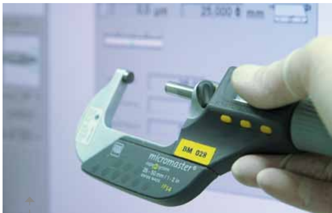
Mess-System-Analyse einer Bügelmessschraube mit der Software von Q-DAS
